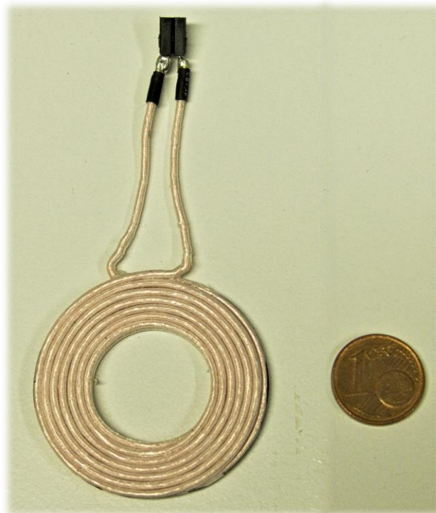
Abbildung 4-26: Spulenvariante mit Litzendraht für die extrakorporale Sendeeinheit.
