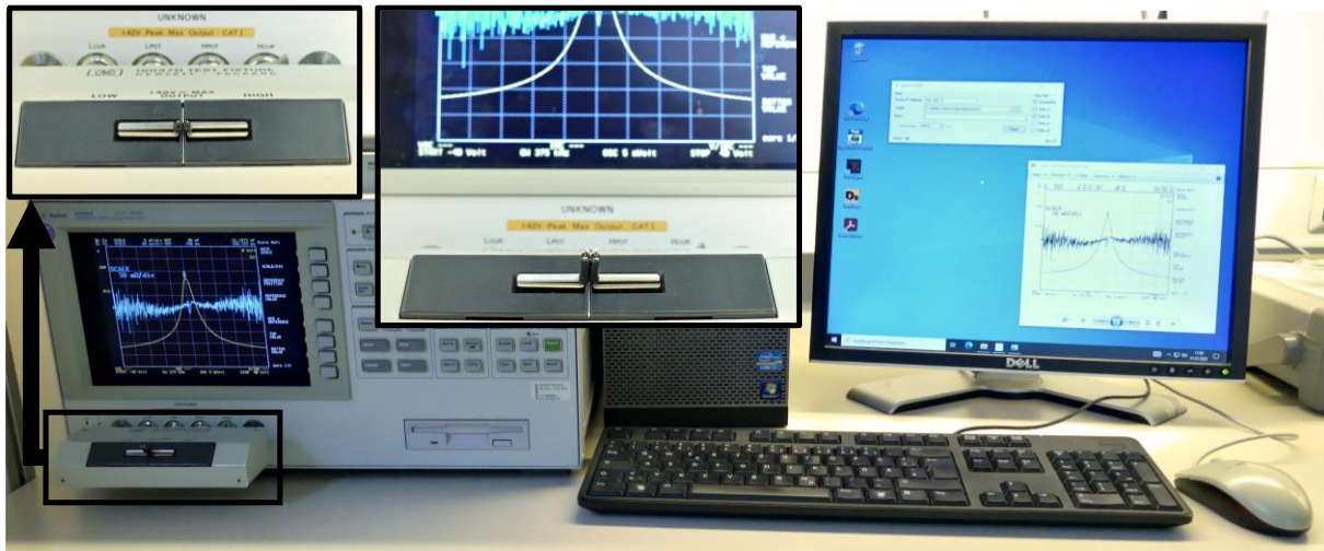
Abbildung 3-1: Präzisionsimpedanzanalysator 4294A von Agilent mit der Messvorrichtung 16047D von Hewlett-Packard zur Messung der Differentialkapazität von MLCCs (links). Die MLCCs wurden auf eine Buchsenleiste gelötet und über eine Stiftleiste in die Messvorrichtung gesteckt. Die Messdaten wurden auf einen Rechner exportiert (rechts).
