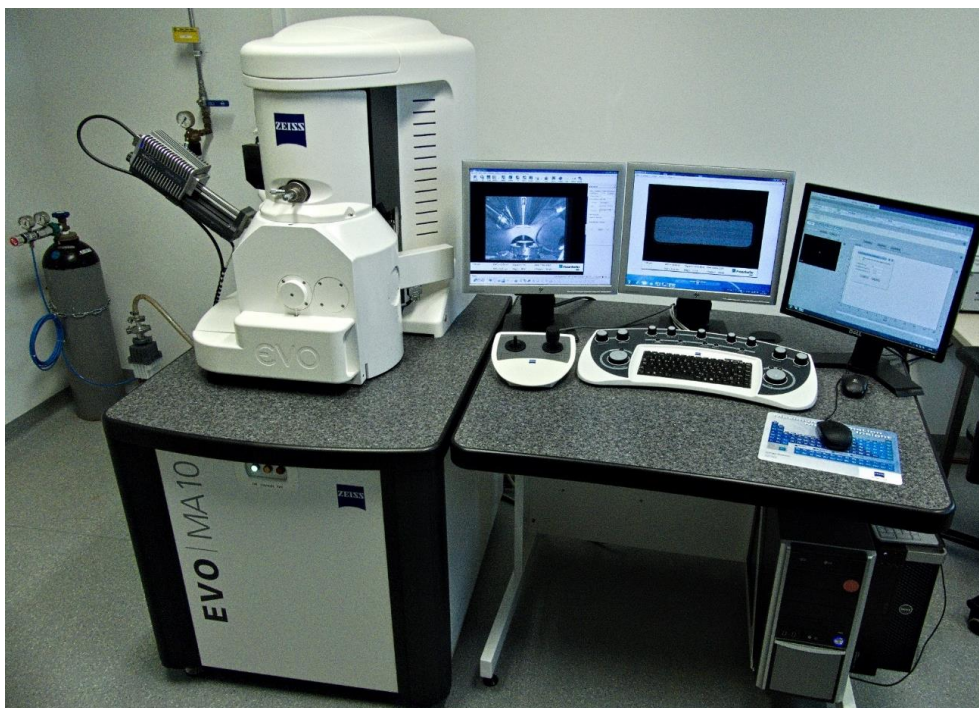
Abbildung 3-9: Rasterelektronenmikroskop EVO MA 10 von Zeiss, um die Materialzusammensetzung der eingesetzten Dielektrika sowie die Struktur der verwendeten MLCCs genauer zu untersuchen.
