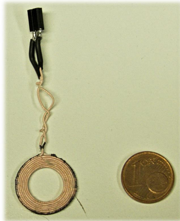
Abbildung 4-29: Spulenvariante mit Litzendraht für die Implantatschaltung.
