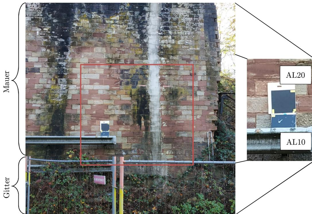
Abbildung 38: Ansicht des Versuchsgeländes mit eingezeichnetem Blickfeld der Kamera (rot) und Zoom auf die Referenzplatten (rechts)
