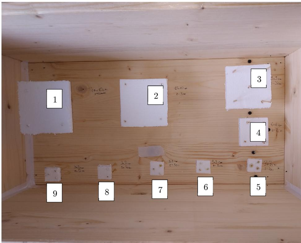
Abbildung 12: Blick von oben in die gefertigte Schalungsform für den Betonblock mit den eingebrachten Ungängen. Zu erkennen sind die einzelnen EPS<sup>20</sup>-Quader, die als Pseudo-Luftein-schlüsse in verschiedenen Größen und Tiefen an Holzspießen befestigt sind.
