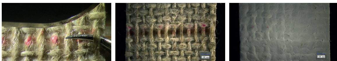
Abb. 12-14: Schnitt der Schussfäden ohne Grundierung, Verklebung und intakte Rückseite.
