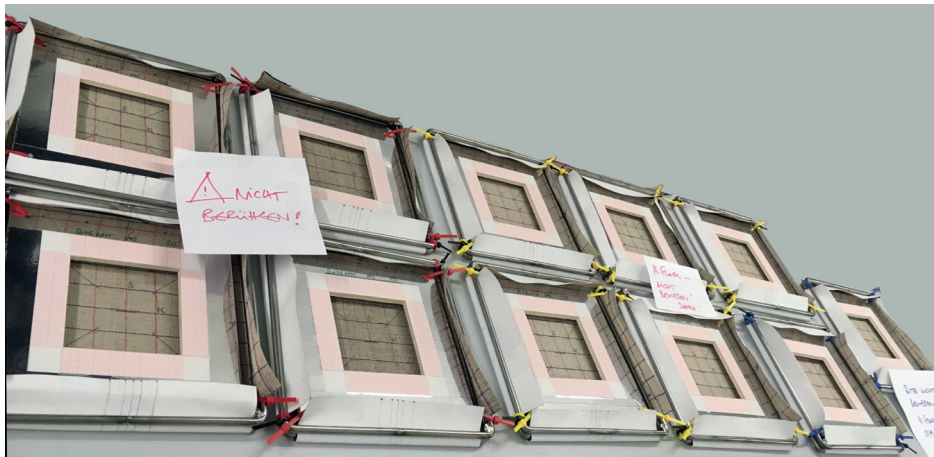
Abb. 10: Serielle Vorbereitung der bereits verklebten Proben zur Aufspannung.
