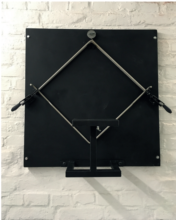
Abb. 01: Befestigungsplatte inkl. Fotostativ-Arm mit eingehängtem Basis-Zugrahmen.
