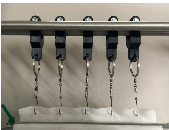
Abb. 11 und 12: Detailansicht der Lager und Aufhängung an den Schenkeln des oberen, doppel-schienigen Rahmenwinkels. Selbiger Aufbau findet sich auch am unteren, einschienigen Teil des Zugrahmens.
