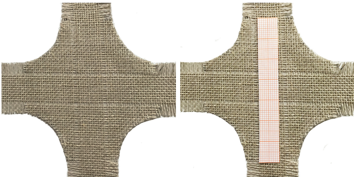
Abb. 02 und 03: Mittelbereich des biaxialen Probekörpers Mod. D (unbeschichtet).
