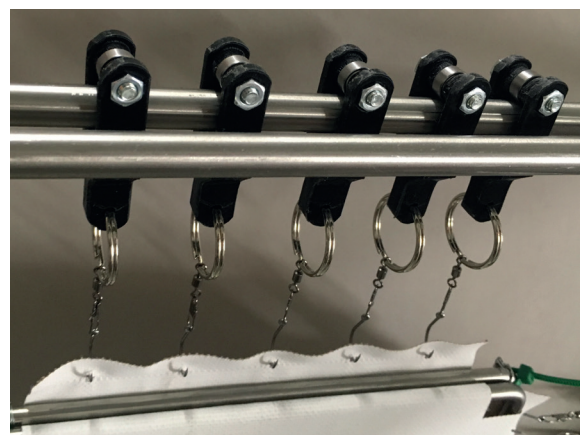
Abb. 11 und 12: Detailansicht der Lager und Aufhängung an den Schenkeln des oberen, doppel-schienigen Rahmenwinkels. Selbiger Aufbau findet sich auch am unteren, einschienigen Teil des Zugrahmens.
