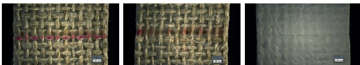
Abb. 09-11: Stoß-auf-Stoß-Verklebung ohne und mit gezogenem Kettfaden im Vergleich. Auf der Rückseite der Probe stellt sich der Schnitt durch die Grundierung dar.
