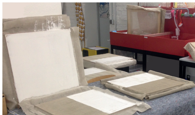
Abb. 05: Arbeitsfoto zur Gewebebeschichtung.
