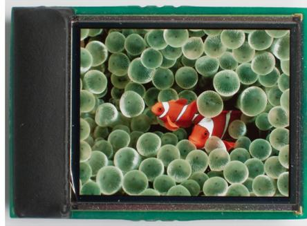
**Abbildung 2.4:** 0,77" Mikrodisplay, Auflösung SXGA (1292 \* 1036), Pixelpitch 12  $\mu\text{m}$  (Quelle: eMagin Corp.).
