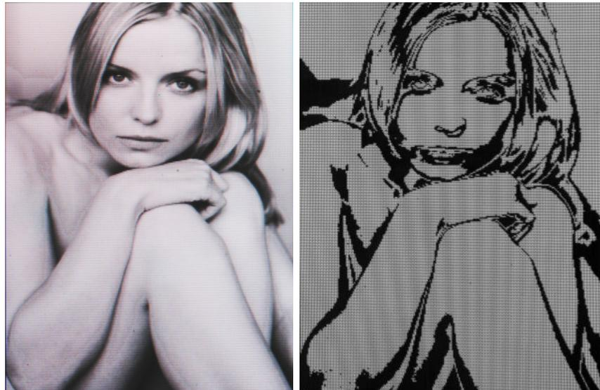
Abbildung 9.7: Aufnahme eines Testbilds mit statischen Konturen und Aufnahme der Subframedarstellung mittels Hochgeschwindigkeitskamera. Die Testbildaufnahme wurde zur besseren Erkennbarkeit im Druck nachträglich aufgehellt.
