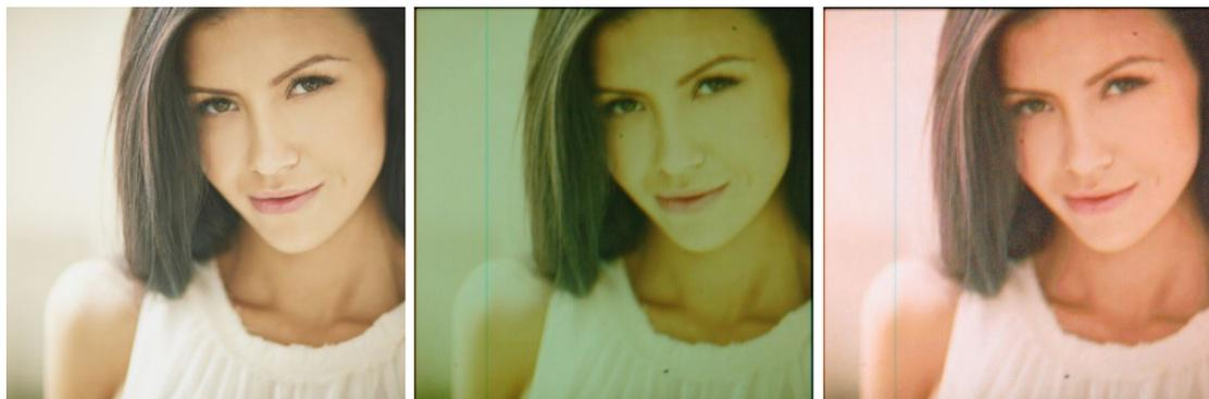
**Abbildung 6.1:** Auswirkung des beschriebenen Weißabgleich auf dem Tianma Prototyp. Von links nach rechts: Quellbild, Darstellung ohne Weißabgleich, Darstellung mit Weißabgleich. Die vertikale Linie ist ein Defekt im Display.
