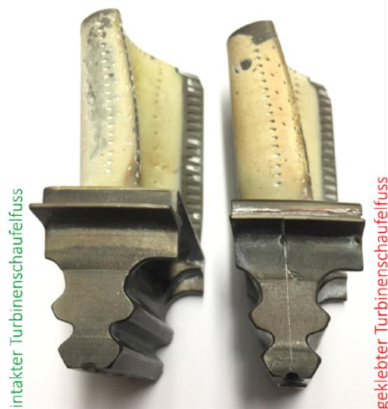
**Abbildung 4.31:** Die beiden mit dem Interferoskop untersuchten Turbinenschaufeln
