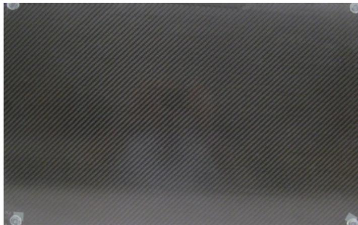
**Abbildung 4.40:** Zu untersuchende CFK-Platte (Abmessungen  $40 \times 80 \text{cm}^2$ )
