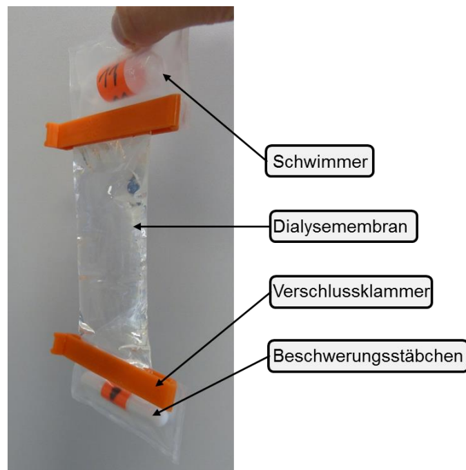
Abbildung 22: Versuchsmembran mit Testlösung.
