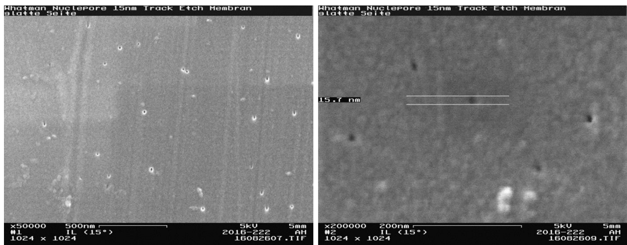
Abbildung 94: REM Aufnahme Track Etch Membrane (15 nm Porendurchmesser)
