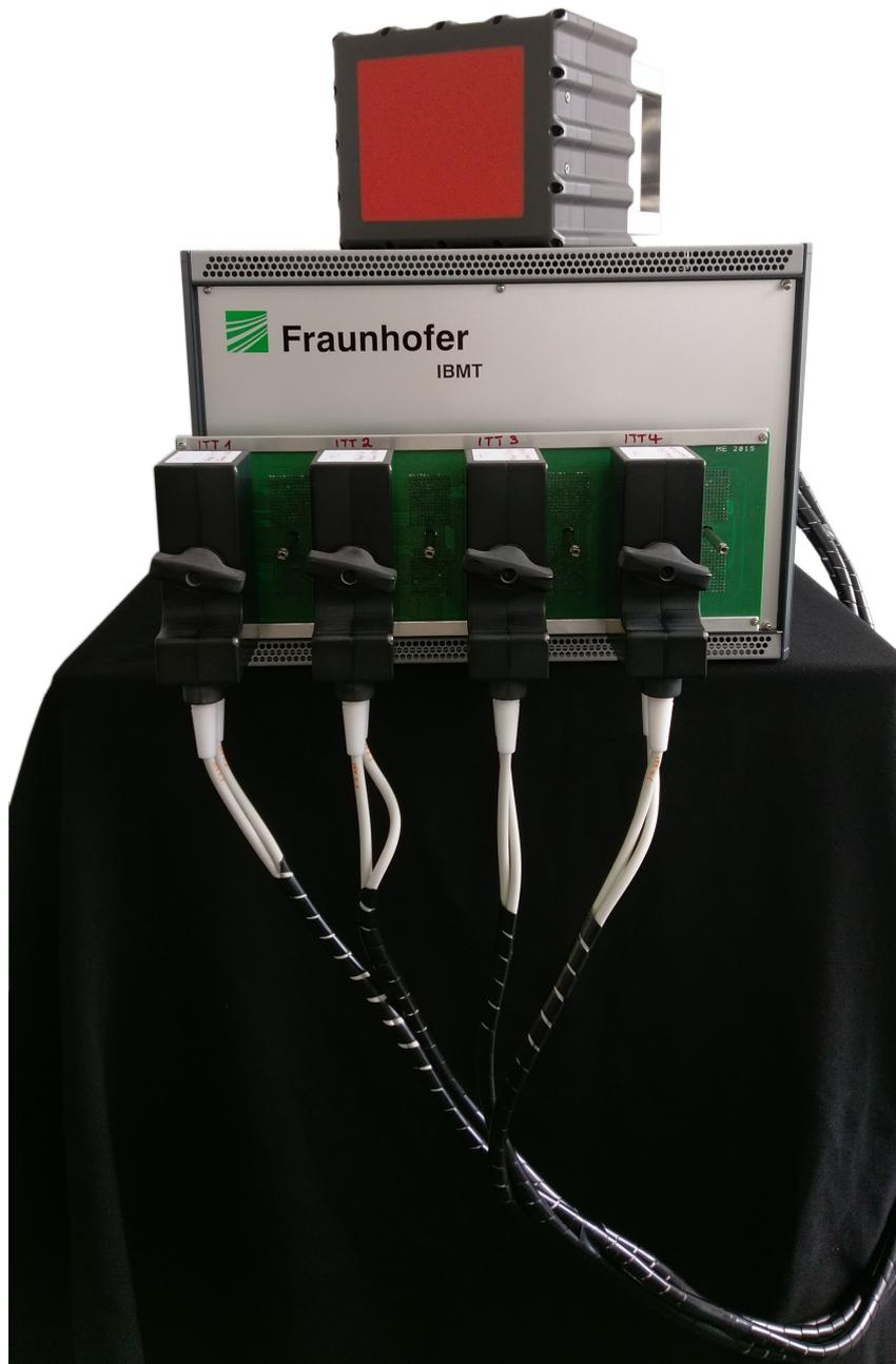
**Abb. 9.3.** Kamerasystem, bestehend aus Antenne und Beamformer.
