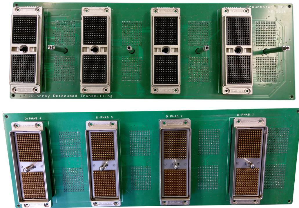
Abb. 9.1. Adapterplatine Antennenseite (oben) und Beamformerseite (unten).
