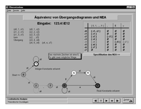
Abbildung 6.1: Äquivalenz von Übergangsdiagramm und NEA (ADLA).
