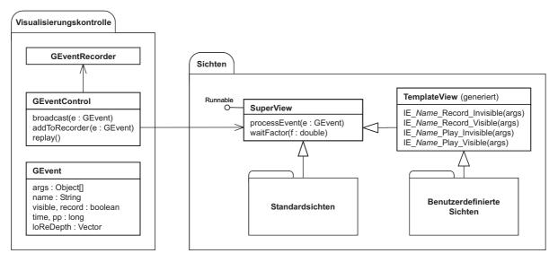
Abbildung 5.5: Kontrolle über die Verarbeitung von Interesting Events und deren Ausführung in den Sichten (UML-Notation).
