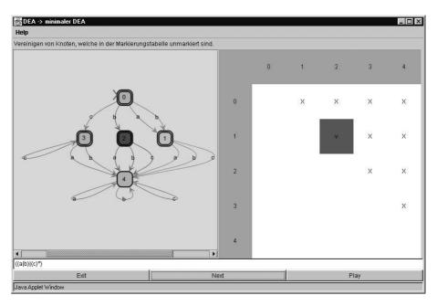
Abbildung 6.12: Animation des Algorithmus  $DEA \rightarrow minDEA$ . Der DEA und der erzeugte minimale DEA akzeptieren die Sprache  $L(a|b|c^*)$ .
