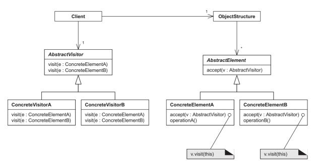
Abbildung 4.2: Struktur des Besuchermusters (UML-Notation, vgl. [Oes97]). Die Darstellung der Klassenoperationen setzt eine Programmiersprache mit Methodenüberladung voraus.
