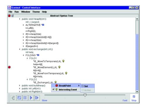
Abbildung 6.7: GUI mit AST des Heapsort-Algorithmus.
