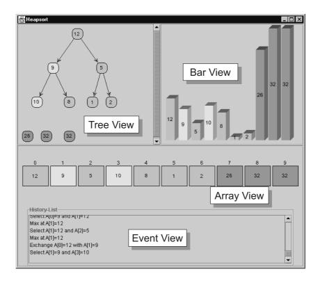
Abbildung 6.8: Ganimal-Algorithmenanimation von Heapsort.
