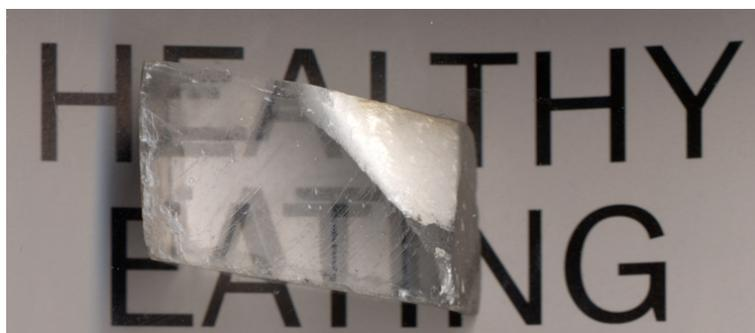
**Abbildung 8.1.:** *Demonstration der Doppelbrechung an Kalkspat ( $\text{CaCO}_3$ ), einem rhomboedrischen Kristall – der Schriftzug erscheint doppelt.*
