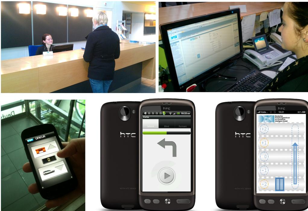
Abbildung 6.9: Übersicht über eine Auswahl an Benutzerschnittstellen zur Steuerung des *Accessible Elevators* im DFKI-Gebäude in Saarbrücken.
