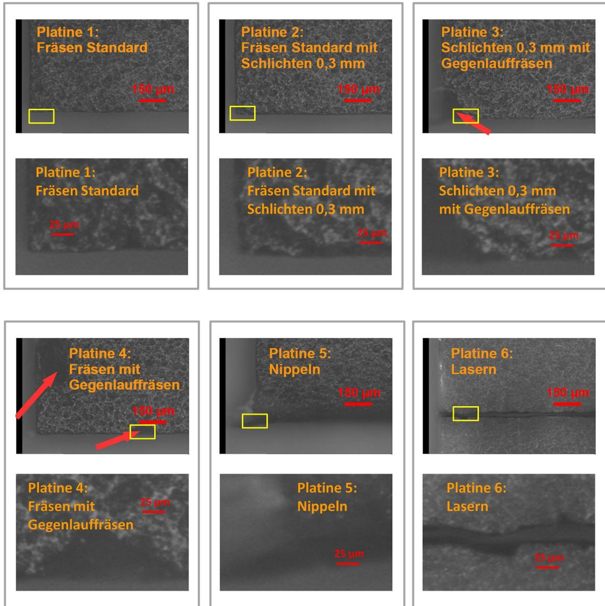
**Abbildung 5.19:** Unterschiedliche Verfahren zur Bearbeitung der Platinenkanten. Zu jedem Bild ist zusätzlich unterhalb des jeweiligen Fotos ein vergrößerter Ausschnitt (entsprechend den gelben Boxen) abgebildet.
