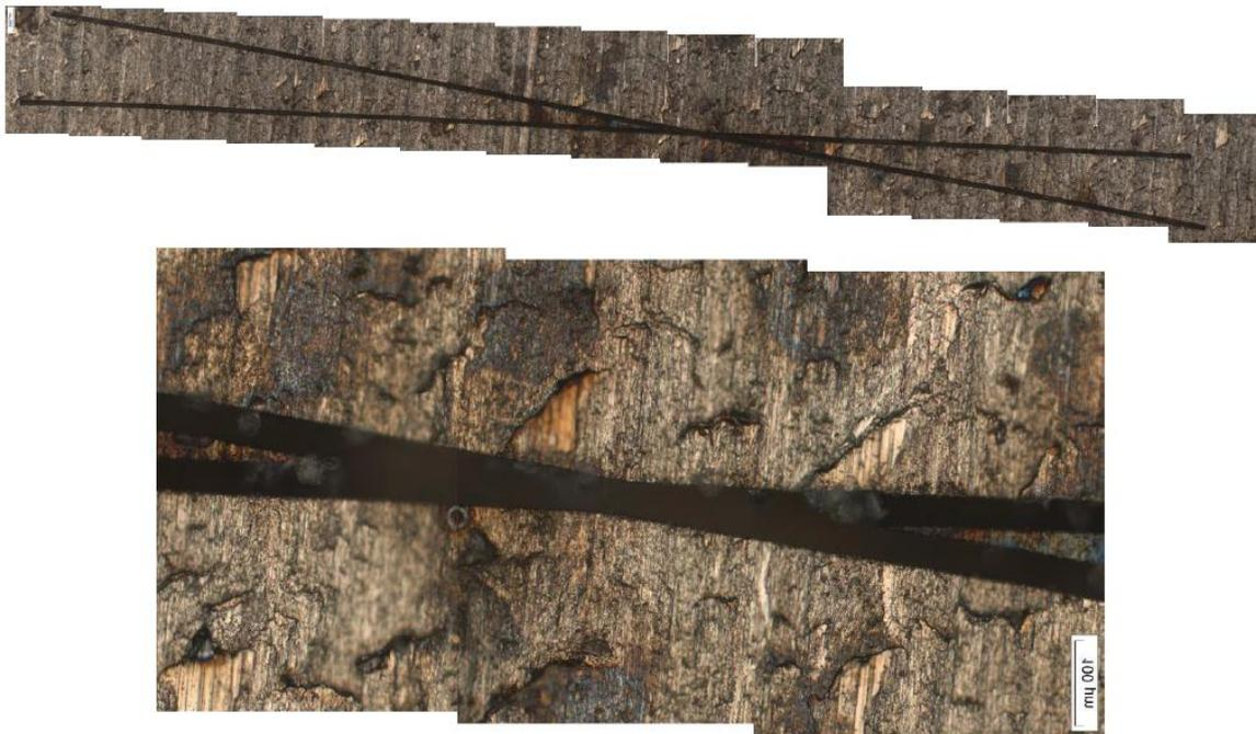
**Abbildung 6.10:** Zusammengesetzte Mikroskopaufnahmen der sich kreuzenden Nuten (Bild Philipp Myrach, Fachbereich Thermografie, BAM).
