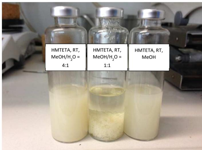
**Abbildung 87:** Beobachtung bei allen Versuchsreihen, hier gezeigt am Beispiel der Polymerisation mit HMTETA bei RT in verschiedenen Lösungsmitteln: Partikel, die in MeOH/H<sub>2</sub>O = 1:1 polymerisiert wurden sind sichtbar agglomeriert, während Partikel aus Lösungsmitteln mit weniger Wassergehalt (MeOH/H<sub>2</sub>O = 4:1 oder reines MeOH) noch immer dispergiert sind.
