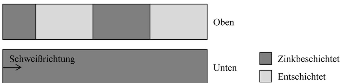
Abbildung 33: Probenpräparation der teilweise entschichteten Bleche aus dem Werkstoff DX51D
