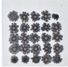
**Abb. 2.51:** Mit  $C_{16}NH_2$ -modifiziertes Substrat, auf welches ein 5x5-Gitter einer 1 M  $Cu_{60}Mn_{40}$  Vorstufenlösungen und einem Applikationsvolumen von 50.000 pL je Spot bedruckt wurde nach einer 30 minütigen Behandlung im UV/Ozon-Reiniger.
