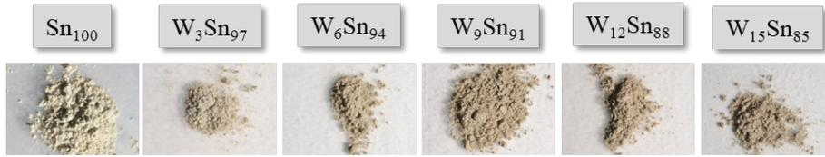
**Abb. 2.18:** Fotografien von reinem und W-dotierten Zinnoxiden unterschiedlicher Dotiergrade bei einer Kalzinationstemperatur von 700 °C über 96 h.
