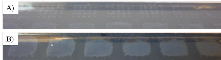
**Abb. 2.64:** Fotoaufnahmen nach dem Druck einer 5x5-Matrix auf einem (A) einfach und (B) dreifach silanisierendem Glassubstrat. In beiden Fällen wurde eine 0,1 M ITO-Vorstufenlösung mit einem Gesamtapplikationsvolumen von 400.000 pL auf einem Spot aufgebracht.
