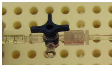
**Abbildung 5.8:** Verbindung einer Spritze mit einem Dreiwegehahn, um Blasen entfernen zu können, bevor sie in den Schlauch gelangen. Dahinter wird der Dreiwegehahn über einen Luer-Adapter mit dem Schlauch in Richtung Eingang verbunden.
