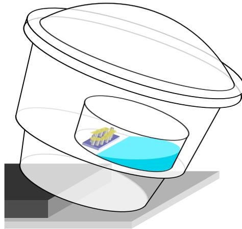
**Abbildung 5.4:** Schematische Zeichnung des Exsikkators während des Luftabpumpens. Er wird gekippt und die Glasschale so mit Isopropanol befüllt, dass der Chip nicht eingetaucht ist.
