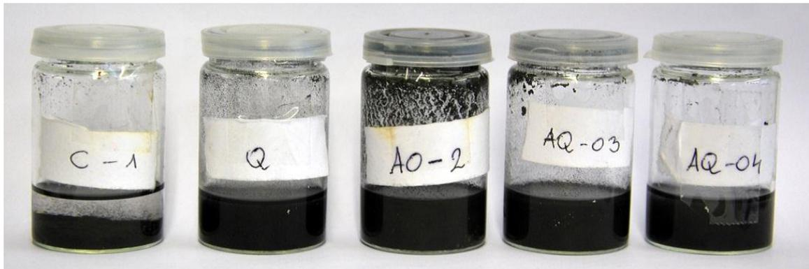
**Abb. 9.17:** Dispergierversuche von verschiedenen GML-Proben in Wasser/Ethylenglycol/Isopropanol-Mischungen
