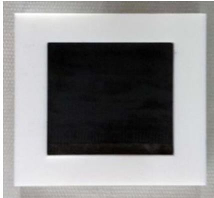
**Abb. 8.7:** Imprägnierschale mit der ausgeschnittenen GDL
