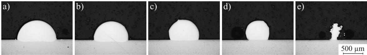
**Abbildung 4.3:** Lichtmikroskopische Aufnahmen der Querschnitte von Einzelschweißspuren in Abhängigkeit der nominellen Laserleistung: a) 530 W; b) 424 W; c) 318 W; d) 212 W; e) 106 W.
