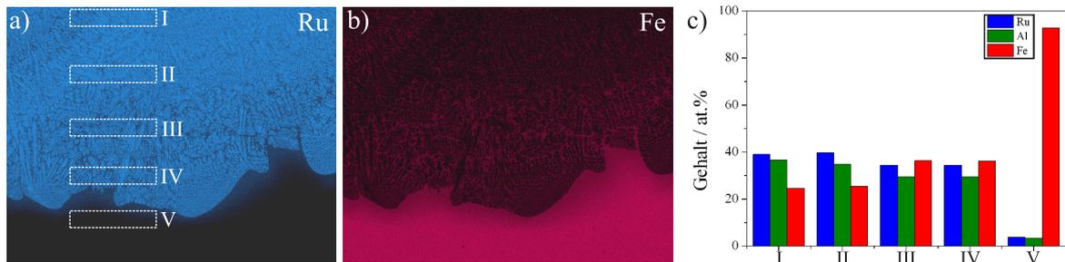
**Abbildung 6.12:** a) und b) Qualitative Verteilung der Elemente Ruthenium und Eisen in Probe L-RA-04, gemessen mittels EDX; c) Quantitative EDX-Analyse der in a) markierten Bereiche.
