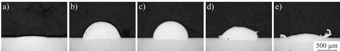
**Abbildung 4.2:** Lichtmikroskopische Aufnahmen der Querschnitte von Einzelschweißspuren in Abhängigkeit des Abstandes zwischen dem Pulverdüsenaustritt und der Substratoberfläche: a) 6 mm; b) 7 mm; c) 8 mm; d) 9 mm; e) 10 mm.
