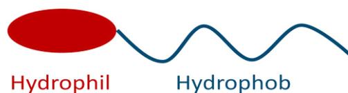
Abbildung 17: Schematische Darstellung eines Tensids.
