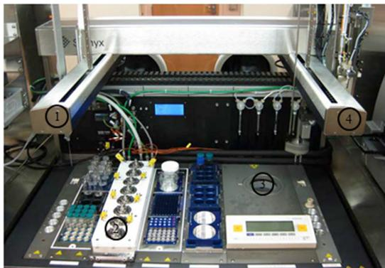
Abb. 32: Workstation for Automated Nanomaterials Discovery and Analysis (WANDA), 1) Entnahmenadel, 2) LTMR-Einheit, 3) Analysenwaage und 4) Vial-Greifarm sowie beheizbare Nadel.<sup>[1]</sup>
