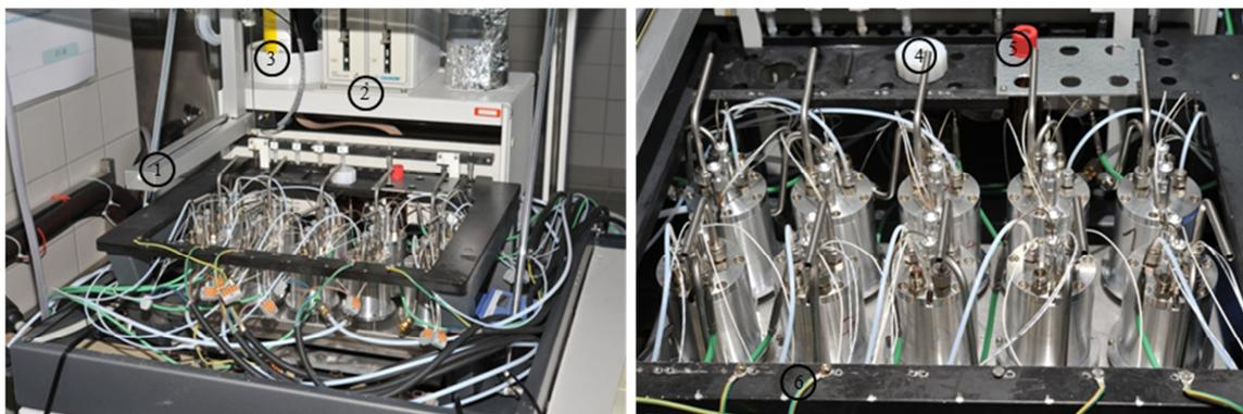
**Abb. 112: Realer Aufbau aller zehn LTM-Reaktoren in der Arbeitsplattform der Chemspeed ASW2000. Zusätzlich zu sehen ist der Roboterarm (1), die Spritzenpumpeneinheit (2), das ODE-Vorratsgefäß (3), die Positionen für die 250 mL Vorratsflaschen (4), die Positionen für die 50 mL Vorratsflaschen (5) und die Erdung am Chemspeedgehäuse (6).**
