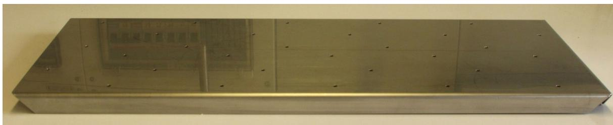
**Abb. 109:** Maske für den 10-Stellen-Mehrfachrührer zur Platzierung der LTM-Reaktoren.
