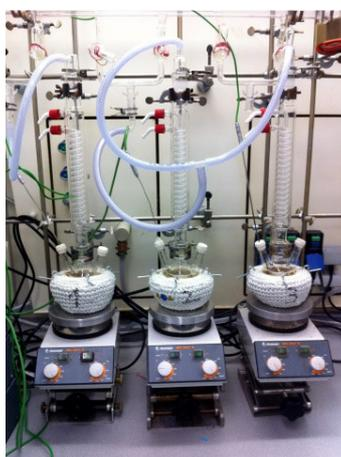
**Abb. 116:** Standardmäßig genutzter Dreifachaufbau zur manuellen Synthese der Chalkogenidnanopartikel.
