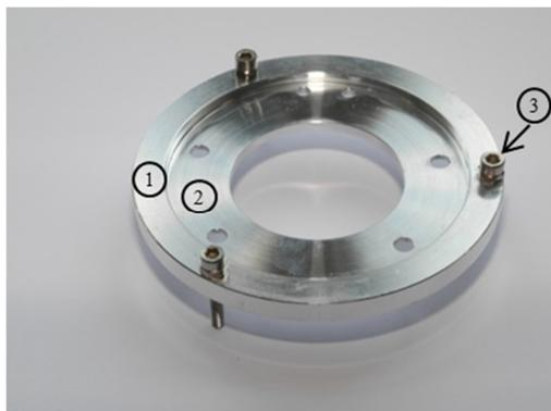
Abb. 103: Reaktorboden mit Standschrauben. (1) Äußerer Kranz, (2) innerer Kranz und (3) Gewindeschrauben.
