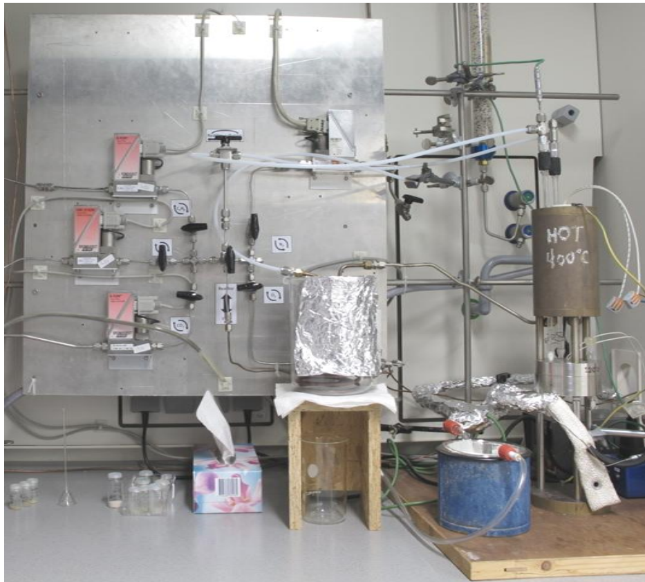
Abb. 3-4: Reaktoraufbau des verbesserten Messaufbaus. Links: Gaszuleitungen, MFC's und Ventile. Rechts: Reaktoreinheit.
