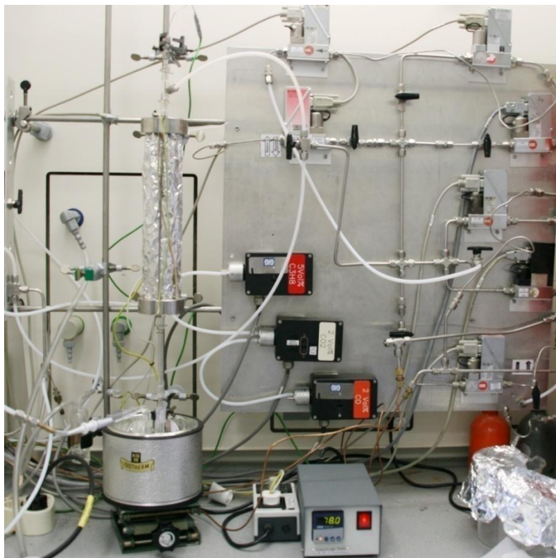
Abb. 3-2: Reaktoraufbau des einfachen Messaufbaus. Rechts: Gaszuleitungen, MFC's und Ventile. Links: Reaktoreinheit und Kühlfalle.
