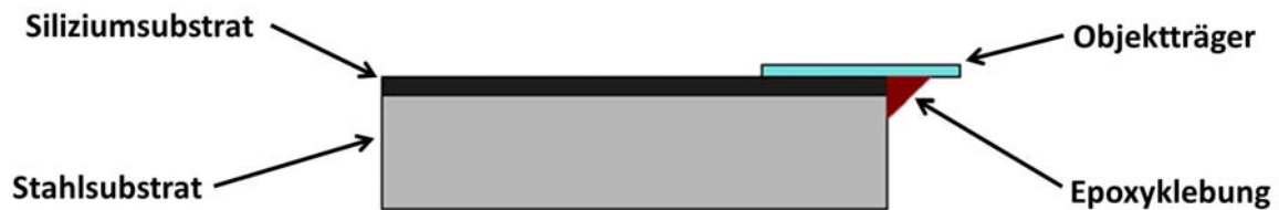
Abbildung 91: Schematische Darstellung der experimentellen Anordnung zur Kalibration der Ölfilmdicke. Dazu wird ein Objektträger auf einem Siliziumsubstrat genutzt, um eine definierte Schmierstoffhöhe einzustellen und somit die resultierenden Graustufenbilder der laser-induzierten Fluoreszenzmessung mit der entsprechenden Schmierstoffhöhe korrelieren zu können (verändert nach [302]).
