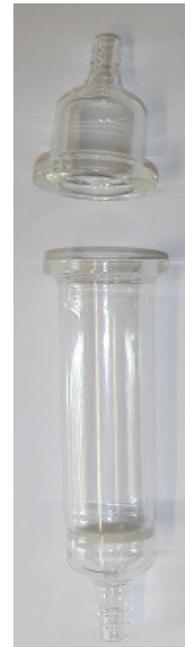
Auch bei dieser Variante sind große Nachteile direkt sichtbar. Zunächst ist es mit diesem Aufbau nur schwer möglich eine konstante Temperatur zu gewährleisten. Das Anbringen einer zweiten Wand ist aus handwerklichen Gründen unmöglich. Somit bleibt nur das gesamte Gefäß in einem Thermostaten zu installieren. Versuche dies zu realisieren sind jedoch gescheitert. Hauptgrund ist die Notwendigkeit alle Geräte oft auseinander bauen zu müssen.
