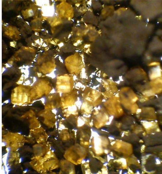
*Abbildung 82: Photo einer Eisenoxalat Probe im Lichtmikroskop. Die gelben Kristalle sind nahezu kubisch bei einer Kantenlänge von ~1 mm. Die braunen Partikel sind eine nicht näher spezifiziertes organisches Nebenprodukt*
