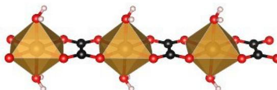
Abbildung 9: Struktur von Eisenoxalat ( $\text{FeC}_2\text{O}_4 \cdot 2\text{H}_2\text{O}$ ); braun: Eisen, rot: Sauerstoff, weiß: Wasserstoff, schwarz: Kohlenstoff; (Bild aus eigener Messung)
