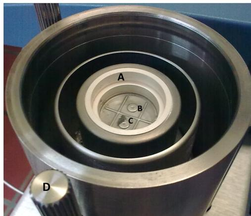
(b) Detailansicht der Druckzelle. Zu sehen sind die Probenkammer (A) mit Plätzen für Referenz- (B) und Proben-Tiegel (C), sowie eine von drei Verschlusschrauben (D).
