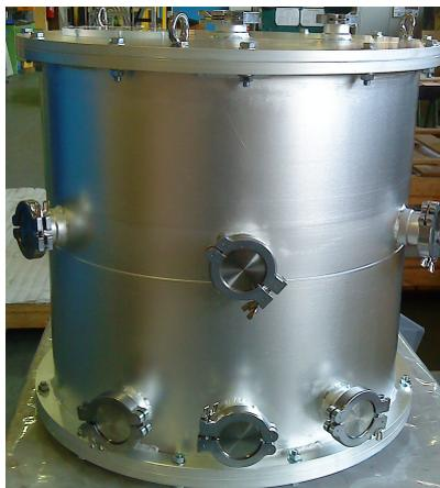
**Abbildung 21:** Aluminiumtopf als Splitterschutz bei der Neutronenbeugung. Zu erkennen sind die Flansche zum Einführen der Laseroptiken und des Pyrometers, die als Kabel- und Gaszuführungen, sowie der als Anschluss für die Absaugung.
