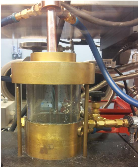
(a) Gesamtansicht des Ofens. Zu sehen sind die Elektrode (Messing oben), die Kühlwasseranschlüsse (blaue Schläuche und Verschraubungen rechts) sowie unten die Bodenplatte (schwarz), durch die der Stempel zugeführt wird.
