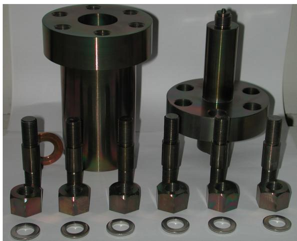
**Abbildung 19:** Großer Autoklav aus *Nicrofer*<sup>®</sup> (zerlegt).
