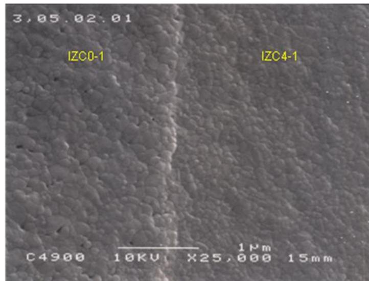
Abbildung 70: HREM-Aufnahme (Vergrößerung 25.000 fach) der Bruchflächen einer freisinternden INM-ZrO<sub>2</sub> / Y-ZrO<sub>2</sub>-Bilayer-Struktur gemäß den Formulierungen IZC0-1 und IZC4-1 nach einem Brand bei 1100 °C und 3 h Haltezeit. Beide Schichtsysteme haben ein sehr dichtes, nanoskaliges Gefüge sowie eine scharfe und defektfreie Grenzfläche. Das ZrO<sub>2</sub>-Gefüge weist größere Körner als das Y-ZrO<sub>2</sub>-Gefüge auf.
