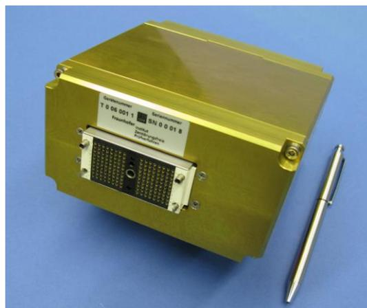
**Abb. 63: Ultraschall-Elektronik-Frontend OPTUS**
