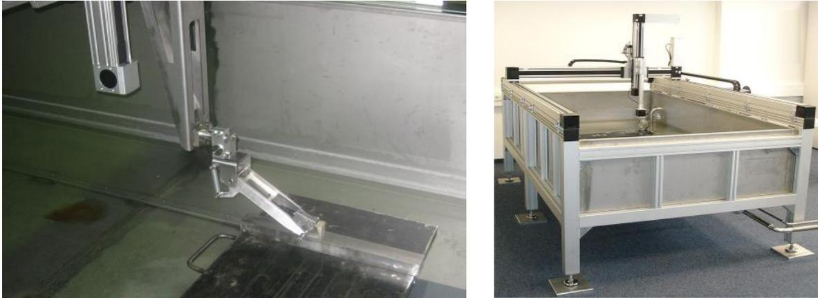
**Abb. 64: SPA-Prüfsystem für Tauch- und Kontakttechnik mit 3-Achsenmanipulator**
