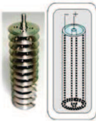
**Figure 2** Cliché photographique de l'anode constituée d'électrodes empilées de titane (gauche), schéma des électrodes du réacteur de Yuksel *et al* (droite) [24]
