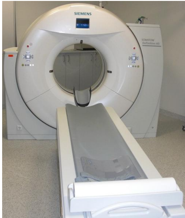
Abbildung 2: CT-Scanner mit Patiententisch und Gantry. [6]
