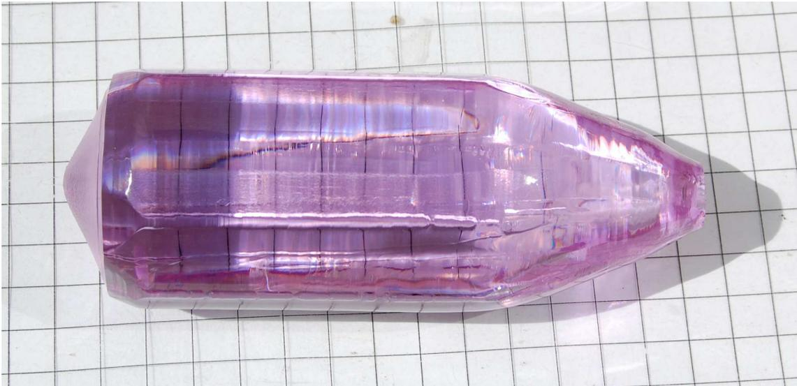
Abbildung 3.22 – Photographie eines Nd:YAG-Einkristalls im Sonnenlicht.
