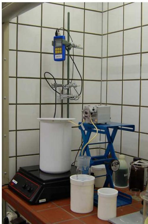
Abbildung 3.2 – Photographie des gerätetechnischen Aufbaus der Fällung. Im Hintergrund der 5l-Teflonbecher mit der Lösung, darüber am Stativ das pH-Meter und rechts die Schlauchpumpe mit dem Glasgefäß der Säurelösung.
