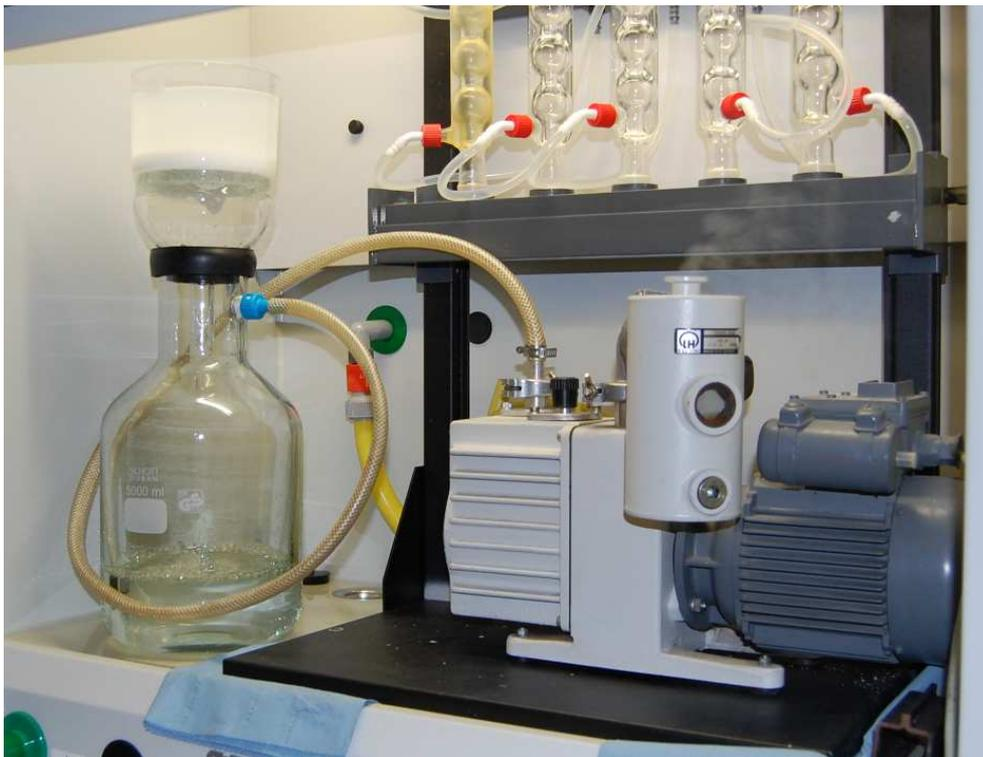
Abbildung 3.4 – Photographie des gerätetechnischen Aufbaus der Filtrierung. Links im Bild die Waschflasche mit der Nutsche und rechts die Vakuumpumpe zum Absaugen der Flüssigkeit in der Nutsche.
