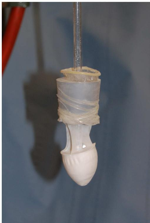
Abbildung 3.17 – Photo der Vorbereitung zur Formgebung; die Schutzhülle aus Latex sitzt auf einem Gummistopfen, der wiederum auf dem Glasrohr sitzt, welches zu der Wasserstrahlpumpe führt. Das Rohr hat einen Durchmesser von 5 mm.
