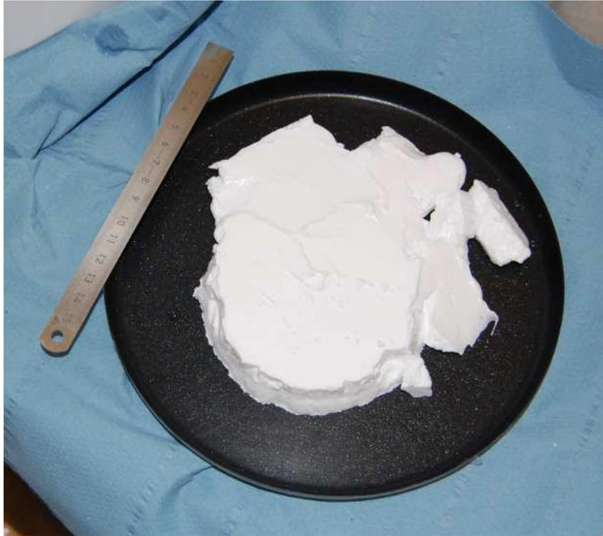
Abbildung 3.7 – Photographie eines typischen Retentats aus der Nutsche auf der beschichteten Edelstahlschale für die Gefriertrocknung. Das Retentat ist die Masse des mit dem Filter zurückbehaltenden Gels.
