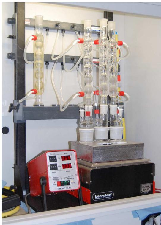
Abbildung 3.1 – Photographie des Aufschlussgerätes der Firma Behro, dass für die Lösung der Ausgangsmaterialien verwendet wurde. Links steht das Gerät zur Temperaturregelung und rechts der Heizblock mit den Glasgefäßen.
