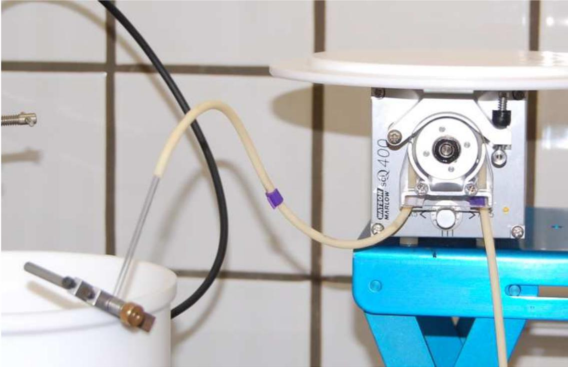
Abbildung 3.3 – Photographie der Schlauchpumpe mit dem Schlauch, der auf das Glasröhrchen für die Injektion der Säurelösung aufgesteckt ist.
