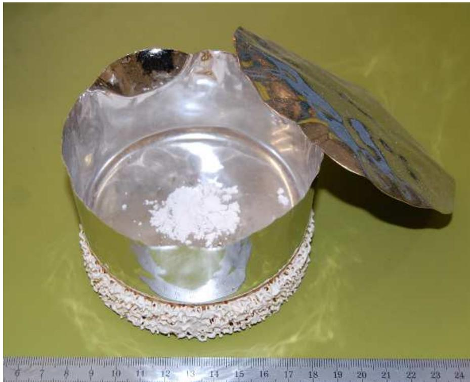
Abbildung 3.8 – Photographie der für die Temperaturbehandlungen verwendeten Platinschale mit einem kleinen Pulverhaufwerk. Die Platinschale steht auf einer Aluminiumoxid-Schaumkeramik.
