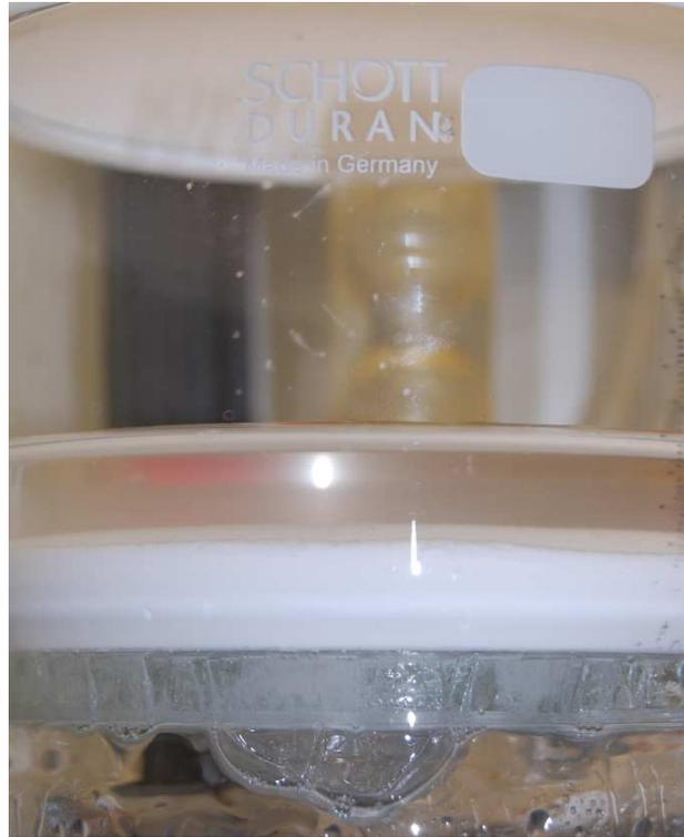
Abbildung 3.6 – Photographie eines typischen Gels mit Flüssigkeit in der Nutsche.
