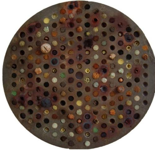
**Abbildung 2-2.** Katalysatorbibliothek befüllt mit binären Mischoxiden nach der Deacon-Reaktion.
