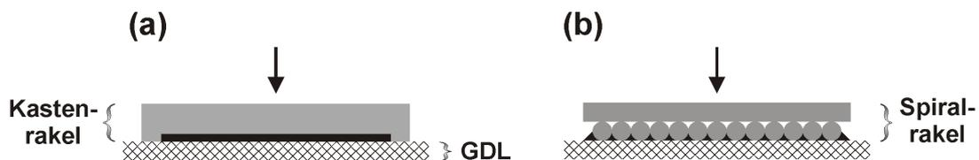
**Abb. 5.7:** Schichtauftrag mit Hilfe von (a) einer Kastenrakel und (b) einer Spiralarakel
