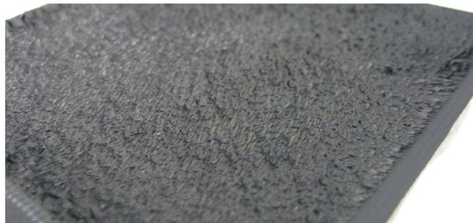
**Abb. 5.9:** Abplatzen der Ruß/Nafion-Schicht von GDL mit MPL
