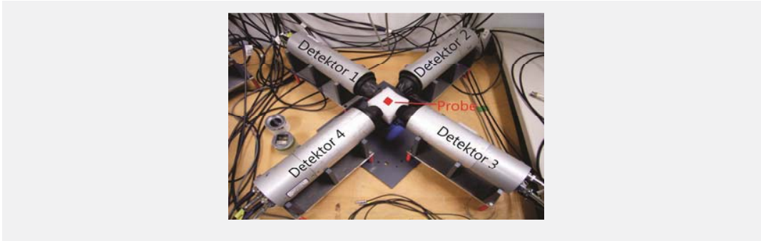
Abbildung 4.4 Prinzip der Vier-Detektor-PAC-Messung.
