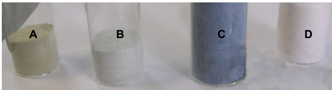
Abbildung 5.5 Die nach dem Reduktionsschritt erhaltenen Produkte A: \text{In}_2\text{O}_3 , B: ITO 2%, C: ITO 5% und D: IH5%
