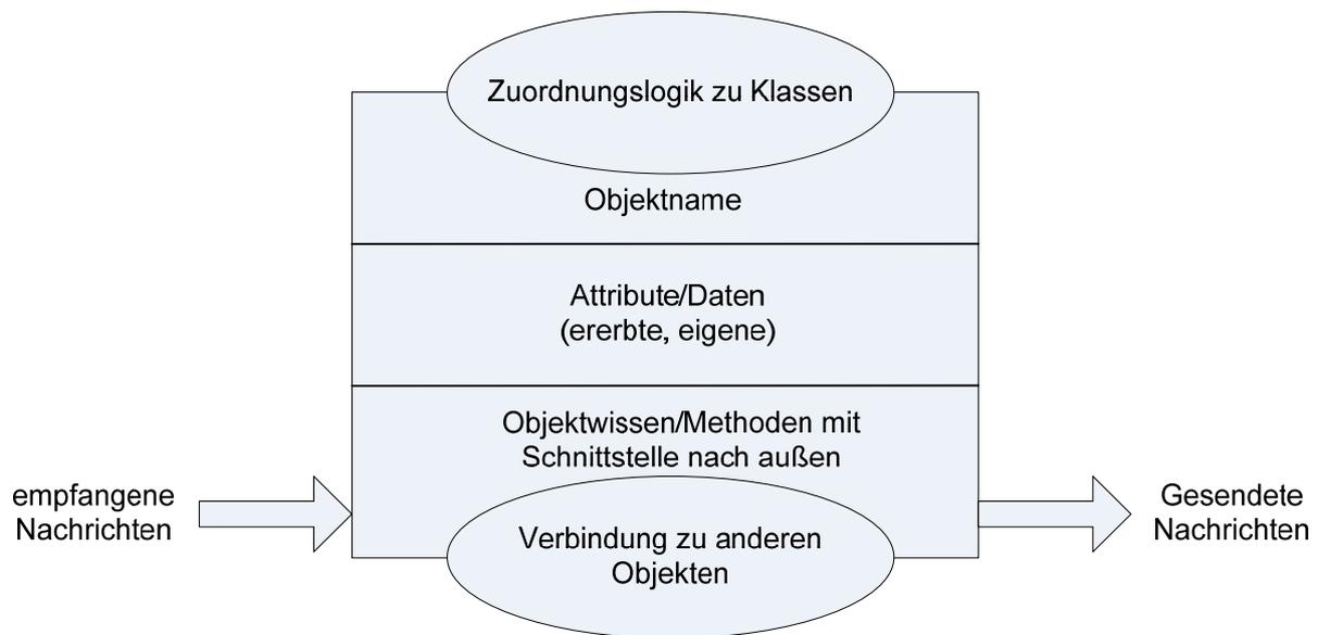
Abbildung 6.3: Aufbau eines Objektes nach [DFG00]
