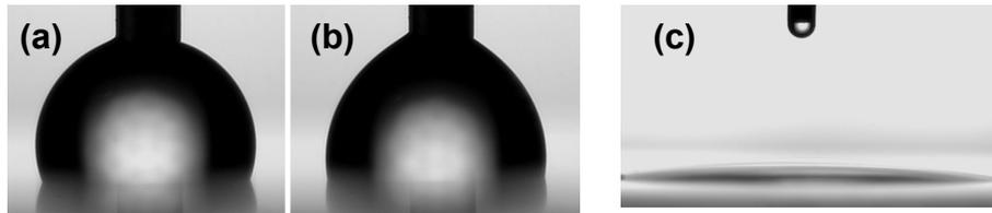
Abb. 21: Photos von Wassertropfen auf der Oberfläche von unbehandeltem Substratpolymer (a) fortschreitender und (b) rückschreitender Kontaktwinkel, (c) statischer Kontaktwinkel nach Behandlung mit Sauerstoffplasma
