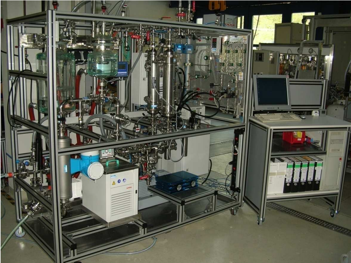
Bild 29: Foto der Technikumsanlage zur Membranfiltration.
