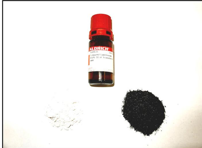
**Abb. 8:** Das ternäre System mit den drei Komponenten Metall (als  $\text{EuClO}_4$ -Lösung, oben), Kaolinit KGa-1b (unten links) und Aldrich-Huminsäure in fester Form (unten rechts)
