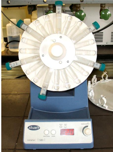
**Abb. 22:** Zur Durchmischung von Suspensionen eingesetzter Überkopfschüttler
