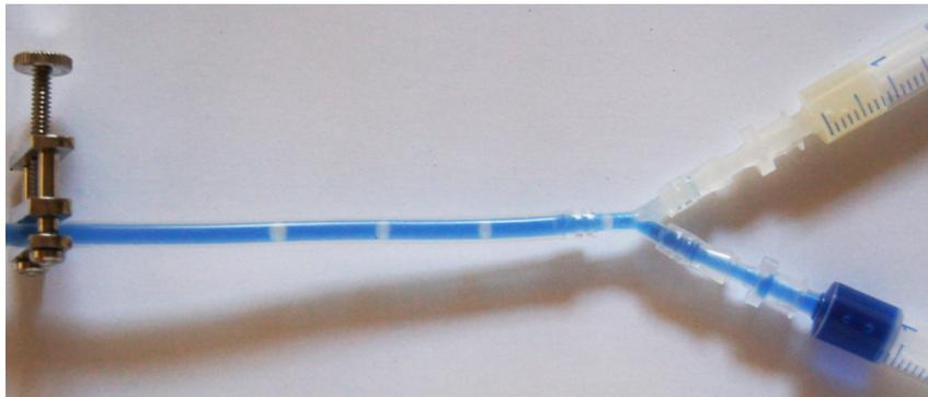
**Abbildung A.5:** Einfache Methode zur Herstellung von Komposit-Mikroträgern: Das noch unvernetzte Kompositmaterial (cremefarben) wird über eine Y-Schlauchtülle in einen Silikonschlauch gespritzt und mit Alginatlösung (zur besseren Sichtbarkeit blau eingefärbt) aus der zweiten Spritze abgetrennt.
