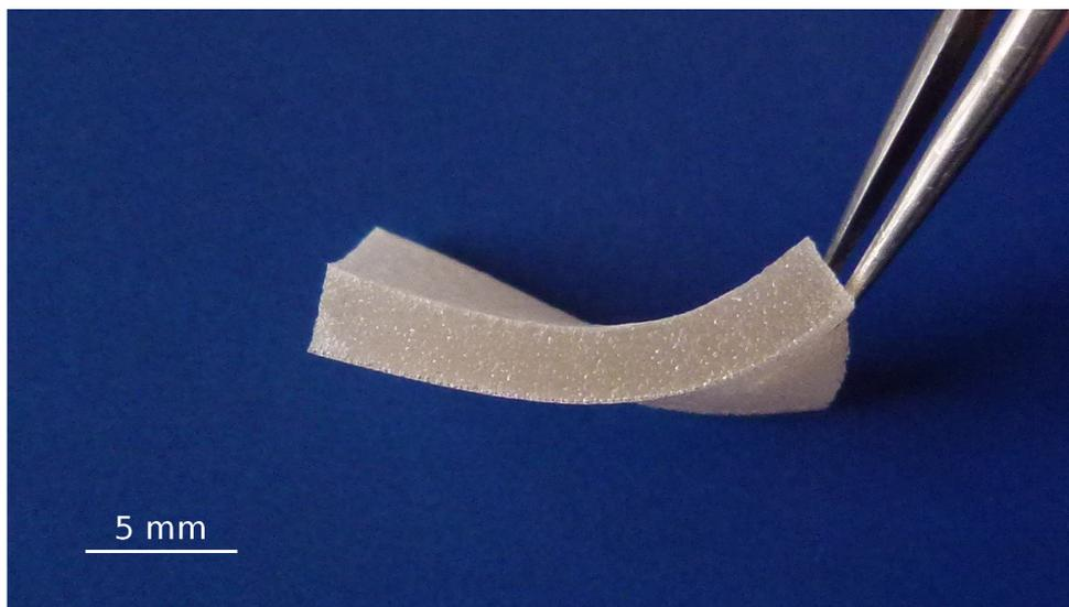
**Abbildung 3.1:** Elastisches PDMS-Alginat-Komposit mit 75% Alginatanteil.
