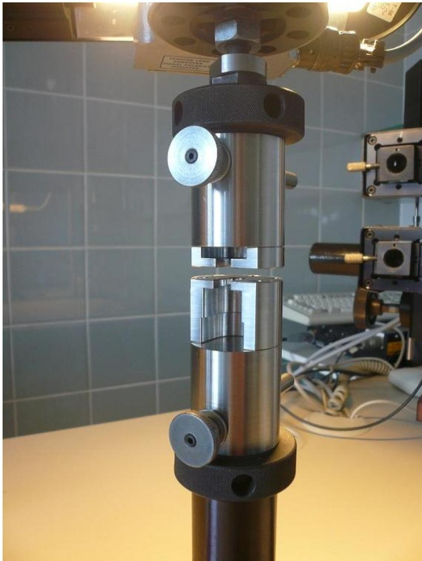
Abbildung 9: Abzugsvorrichtung der Universalprüfmaschine
