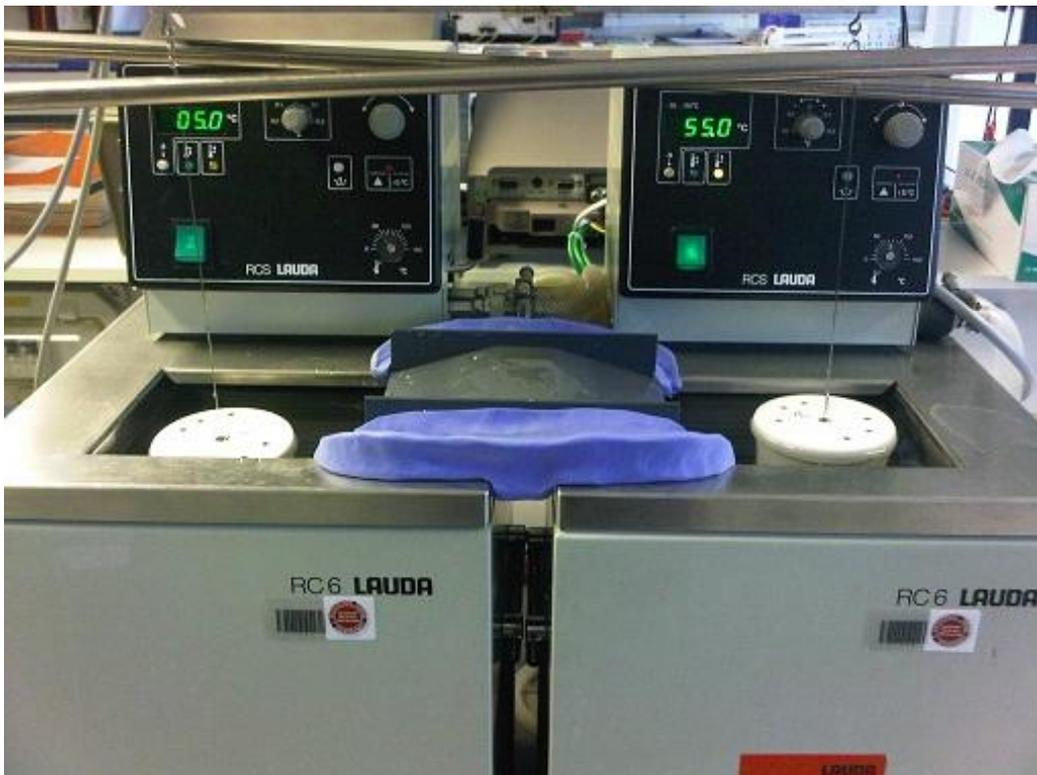
Abbildung 6: Versuchsaufbau für die thermische Wechselbelastung
