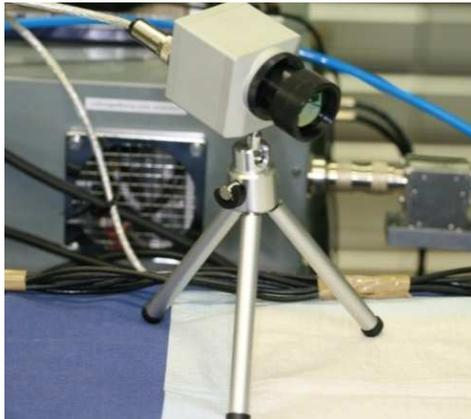
Abbildung 12: Infrarotkamera Optris PI für die Wärmebestimmung. Quelle: S. Rupf, Universität des Saarlandes.
