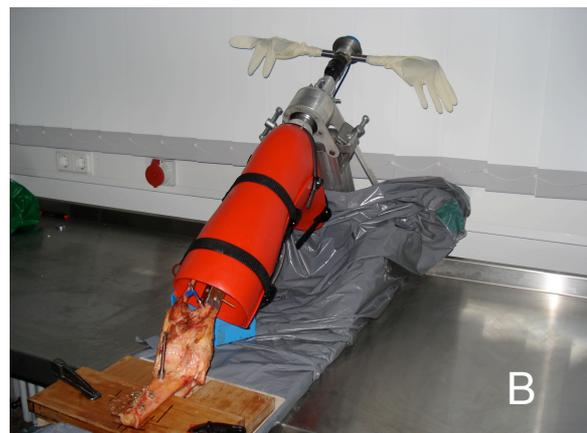
Abb. 2: (A) Rotameter. (B) Rotameter mit Präparat. Das Präparat ist distal mit der Gipsprothese verbunden und darüber im Schuh fixiert. Proximal erfolgt die Fixierung mittels fester Verschraubung mit der Unterlage.
