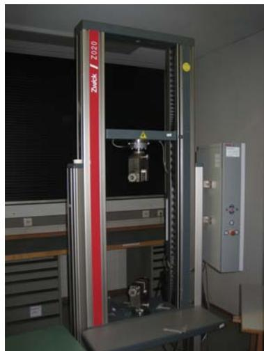
Abbildung 6: Universalmaterialprüfmaschine (Modell: BTC-FR020TH.A50, Zwick GmbH & Co. KG, Ulm, Deutschland)
