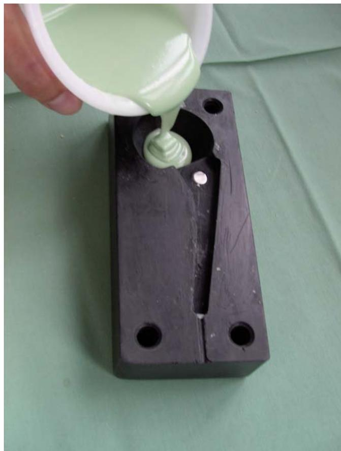
Abb.7: Eingießen des flüssigen PMMA's in die Gussform.
