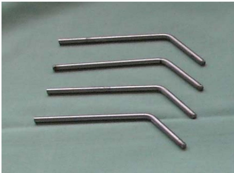
Abb.2: Bearbeitete TiAl 6V4-Metallendoskelette vor dem Einbau
