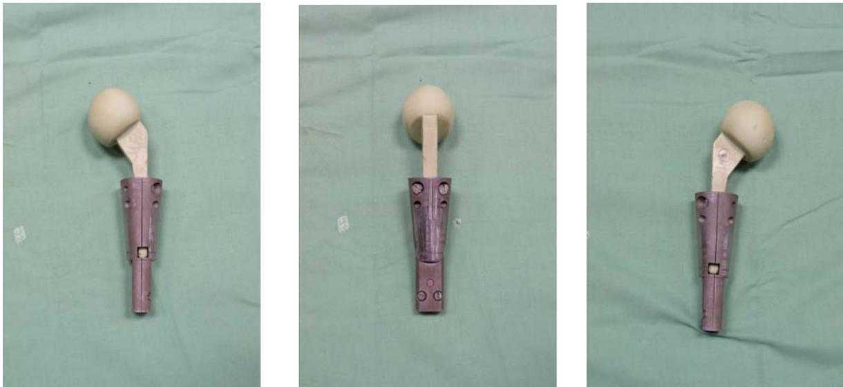
Abb.11: Die Abbildung zeigt einen in zwei Halbschalen fixierten PMMA-Spacer wie er bei der Testung verwendet wird.
