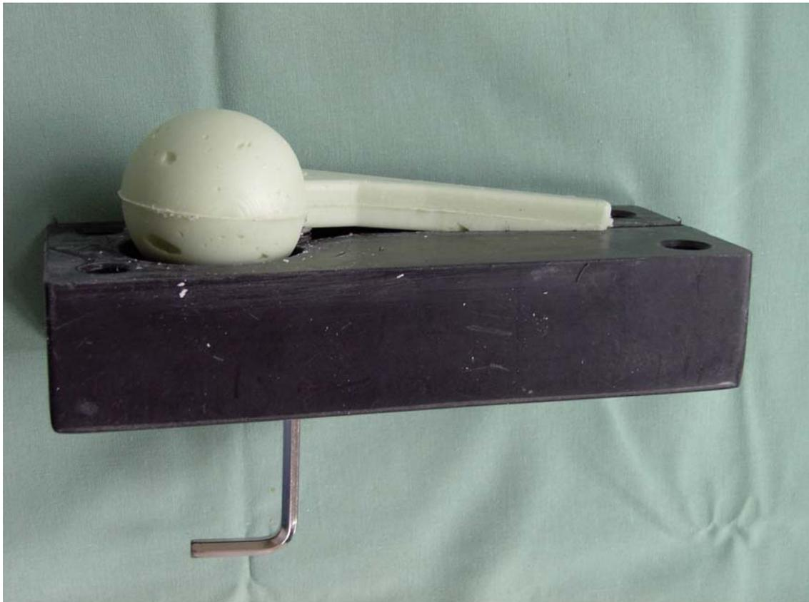
Abb.8: Ausgehärteter Spacer wird aus der Gussform herausgeholt.
