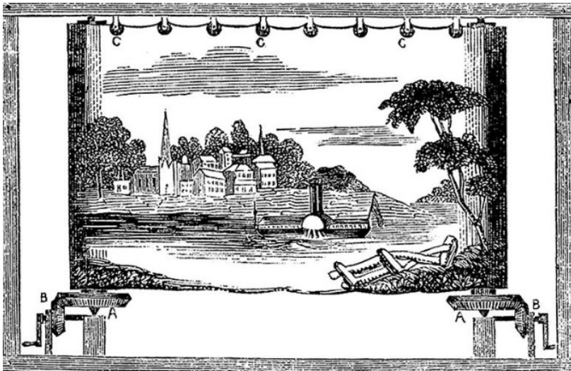
Fig. 4: Mecanismo de un panorama móvil de John Banvard. Scientific American 4, n. 13 (Dec. 16, 1848: 100).
