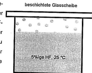
Bild 1: Testaufbau: Glas mit Beschichtung auf der Unterseite (Sn-Seite) in der gesättigten Gasphase einer 5%igen HF-Lösung bei 25°C
