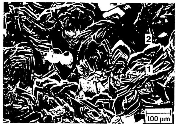
Bild 3. Oberfläche des Glases MI nach künstlicher Bewitterung (16 h, 20^\circ\text{C} , 76 % r. F., 2000 ppm \text{SO}_2 ). 1: Syngenit, 2: Gelschicht.
