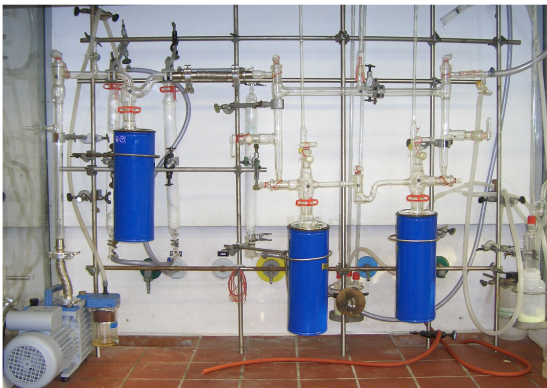
Abbildung 6.1: Aufnahme einer modifizierten Stock'schen Vakuum- und Inertgasapparatur
