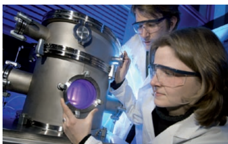
In der Plasmakammer werden Werkstoffe mit Schichten veredelt.
