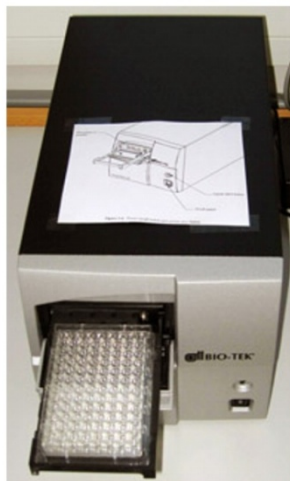
Abb. 2.27: UV/Vis-Multiplattenreader (Biotek PowerWave) zum Hochdurchsatz-Prescreening der Säurestabilität synthetisierter Katalysatormaterialien mit eingesetzter Multititer-Quarzglasplatte
