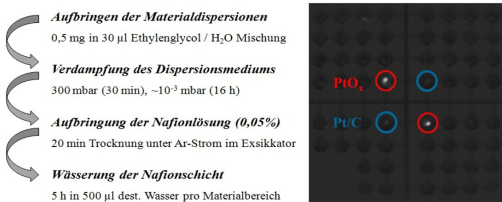
Abb. 2.18: Die einzelnen Schritte der Beschichtungsmethode nach Welsch [25] (links) und die Auswirkung dieser Methode auf das Fluoreszenzverhalten der Referenzmaterialien \text{PtO}_x und Pt/C, dargestellt durch ein hintergrundkorrigiertes Bild der Arbeitselektrodenplatte nach 15 min (rechts).
